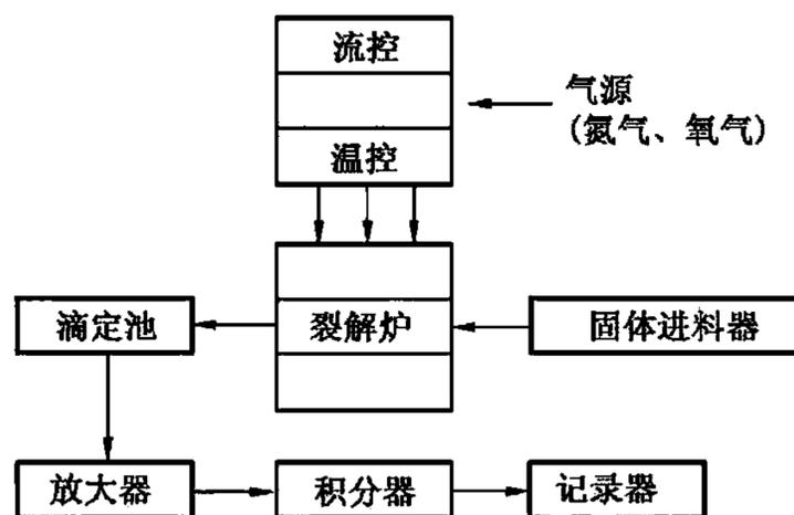
图 A.1 微库仑测定氯含量流程框图
